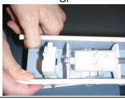
Glissez la tringle d'inclinaison de nouveau dans le mécanisme. Soyez sûr les tambours de ruban sont en position ouverte avant d'insérer la souche.
