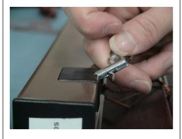
12. Poussez le clip de connecteur vers le bas et vers le côté de la souche d'inclinisation. Alignez le clip de connecteur vers le bas sur le côté court sillon de la tige du mécanisme.
