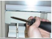
3. Enlevez la tige. Si le store a une tige avec un clip de connecteur, utilisez des pinces nez aiguille à saisir le clip de connecteur de tige au-dessous de la tige du mécanisme. Tordez le fil pour dégager de rainures dans le mécanisme d'inclinisation.
