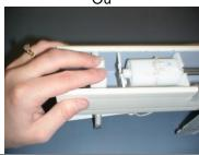
6. Doucement répandre les côtés du rail de retenue et tirez le mécanisme d'inclinisation au-dessus et hors du rail de retenue
