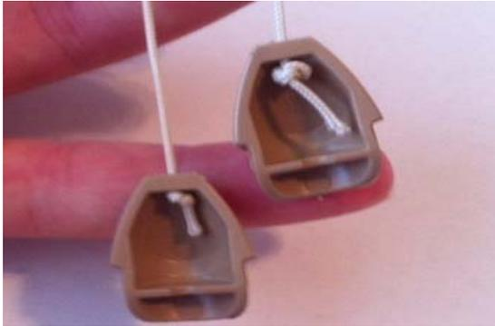
2. Positionnez le nœud du Danskord™ de la moitié basse du dispositif de libération du cordon à l'intérieur de la moitié supérieure (Remarque: Si cette étape est ratée le dispositif viendra à part lorsqu'il est utilisé)
