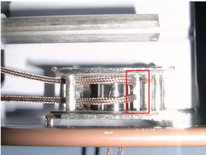
10. Enfiler le cordon à travers l'ouverture du verrouillage de cordon.
