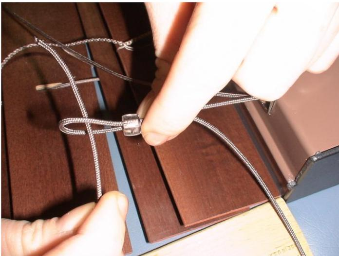
20. Confirmer que la perle de l'arrêt est située 1 à 2 po en-dessous des supports. Poussez le cordon dans le sillon du côté de la perle et serrer le nœud fermement. Tirez le nœud à l'intérieur de la perle de l'arrêt. Répétez pour la deuxième perle d'arrêt.
