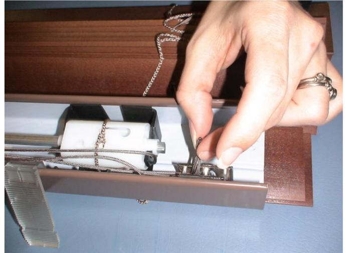
7. Placez un tournevis plat à l'intérieur du verrouillage de cordon et le pousser vers l'arrière du rail de retenu. Le verrouillage de cordon devrait se désengager.
