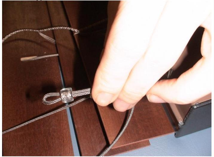
19. Jugeant la perle de l'arrêt en position, insérez l'extrémité coupée de la corde dans la boucle de cordon et tirer jusqu'à ce que le nœud est formé autour de la perle.
