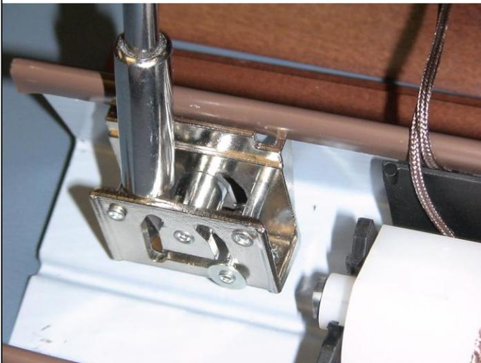
8. Enfiler les cordons sous le côté du nouveau verrouillage de cordon, sur le rouleau lisse et à travers le verrouillage de cordon en face du cylindre dentelé.
