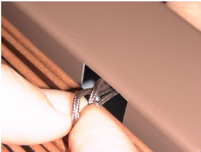
11. Faites glisser l'avant du verrouillage de cordon sous la levée à l'avant du rail de retenu jusqu'à ce qu'il soit positionné sur le trou dans le rail.
