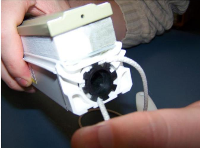
5. Desserrez l'embrayage en insérant un tournevis entre l'embrayage et le rail de retenue.
