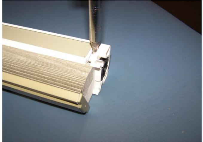
6. Retirez les vis du disque et de l'embrayage. Conserver les vis pour plus tard.
