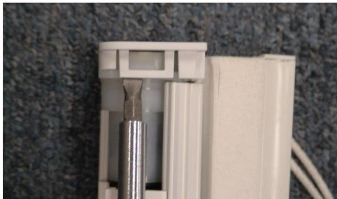
4. Retirer le diviseur de corde hors du mécanisme.
