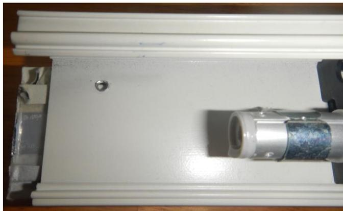
12. Réinsérer le nouveau mécanisme et serrer la vis à l'intérieur pour maintenir le mécanisme sur place.
