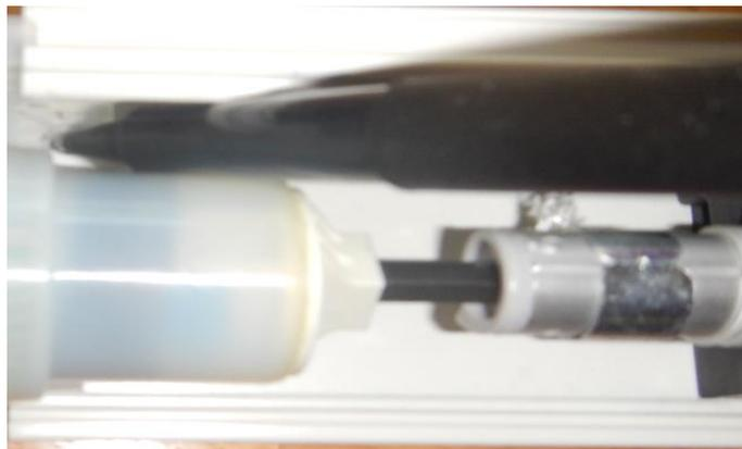
11. À l'aide d'une perceuse et d'un foret 32, percer avec soin un trou à l'endroit marqué à l'intérieur du rail. Prendre garde à ne pas endommager le tissu.
