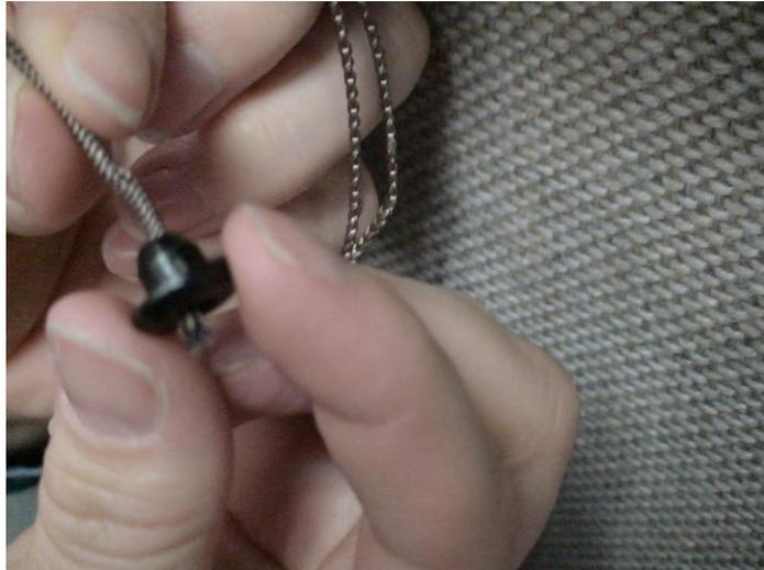
5. Coupé l'excès de cordon. Insérez le cordon sertissage et échelle de laiton dans le trou du rail de bas. Poussez les clous en place sur le rail de bas.
